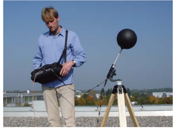
Medidas con el analizador de espectro portátil y la 9171 Isotropic Antenna
